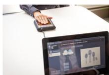
S'appuyant sur la technologie TFT (Thin-Film Transistor<sup>1</sup>), ce nouveau terminal extra fin permet la capture des 10 doigts à plat ou en enroulé. Sa vitesse et sa qualité d'acquisition sont incomparables (capture des doigts possible en moins de deux secondes, performances améliorées pour les doigts secs, finition étudiée pour éviter les traces).
